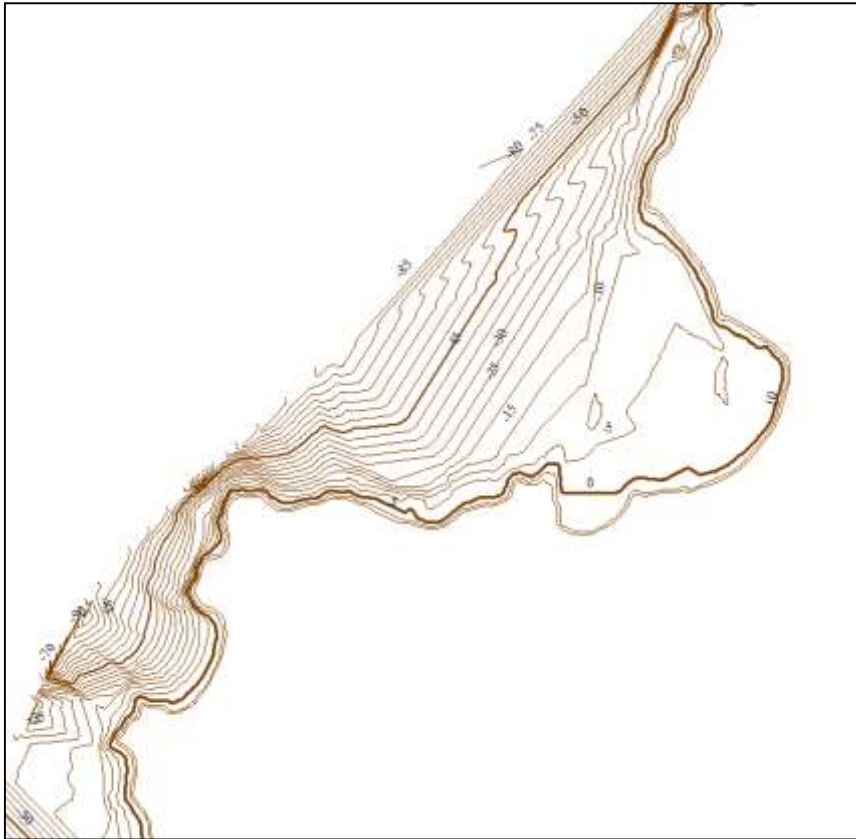
Gambar hasil generate kontur dengan interval 5 meter
